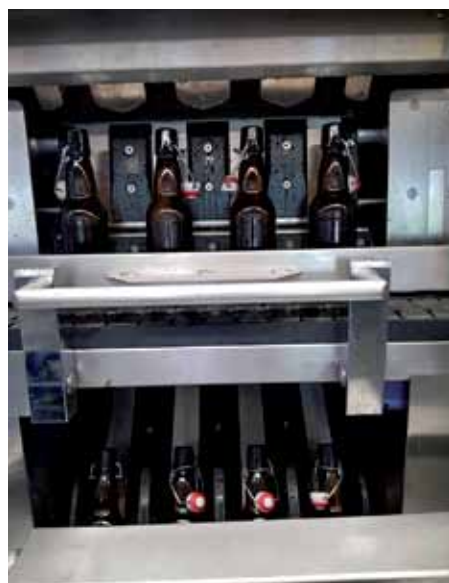
Bis zu 1800 Flaschen stündlich kann die Waschmaschine mit wenig Wasser, Energie und Reinigungsmittel reinigen
